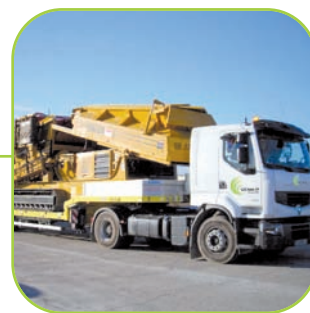
Semi porte engin double rampe compatible finisseur
